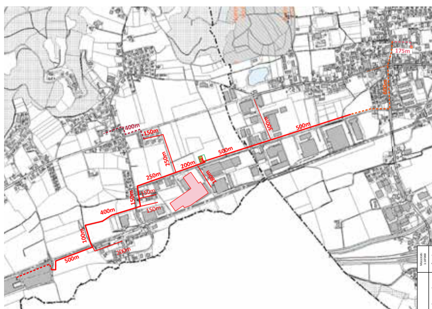
Die bis im Jahr 2044 angepeilte Vision: Ein auf rund 5 Kilometer ausgebautes Fernwärmenetz soll Reider und Wikoner Quartiere mit CO 2 -neutraler Energie versorgen. Dies mit einer zentral betriebenen Schnitzelheizung im Industriegebiet. Illustration vlg
